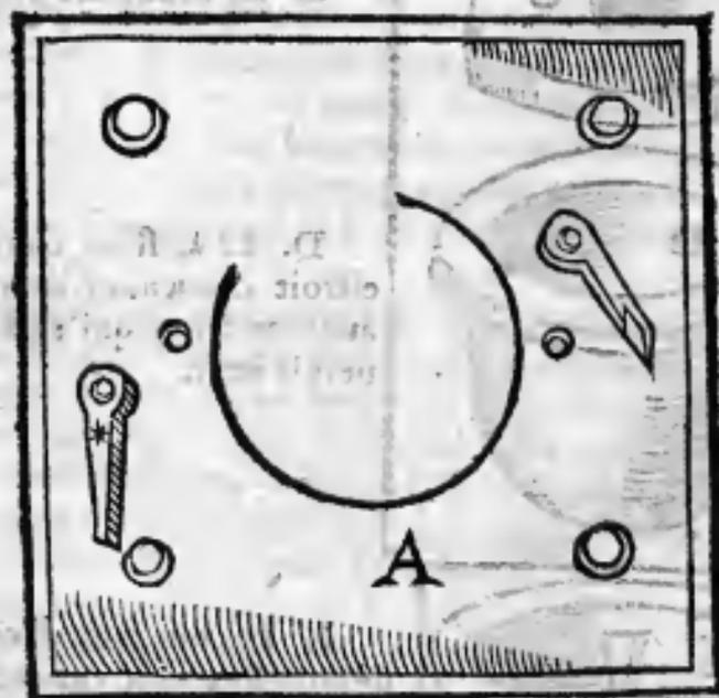
A la lamè de fer quarree, qui doit estre posee sur le goder qui contient le vin ayant quatre grands trous, afin qu'elle puisse estre attachee au goder pour empescher de se mouuoir. Elle a aussi deux petits trous, correspondans aux deux trous du cercle B. afin que s'il est besoin de l'y mettre, il puisse estre asseuré. En la mesme lame vous voyez deux crochets marquez par deux petites estoilles, pour contenir le vaisseau mis dedans le grand trou,
